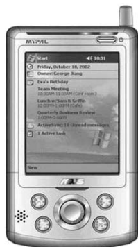
Рис. 3. Карманный компьютер ASUS MyPal, использующий карты flash-памяти SecureDigital Card
