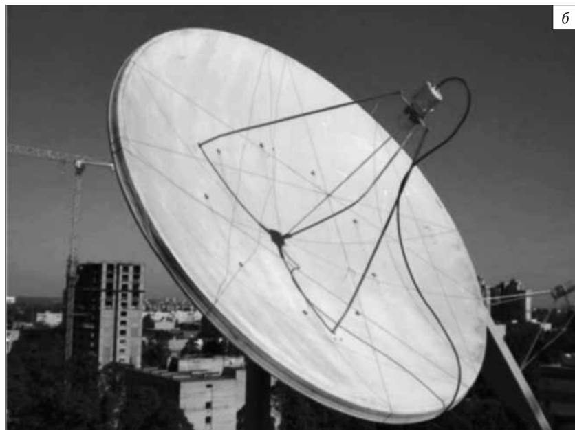
Рис. 1.4. Зеркальные антенны: а — 1930-е гг.; б — современная антенна
