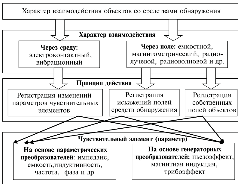
Рис. 1.1. Общие принципы взаимодействия объекта (нарушителя) со средством обнаружения
