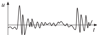
Рис. 1.1. Осциллограмма звукового сигнала
